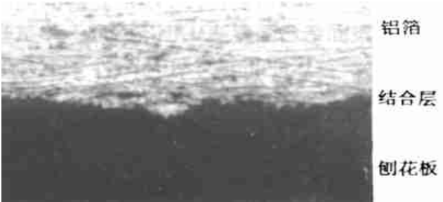
图 1 复合板横断面结构(125倍)
